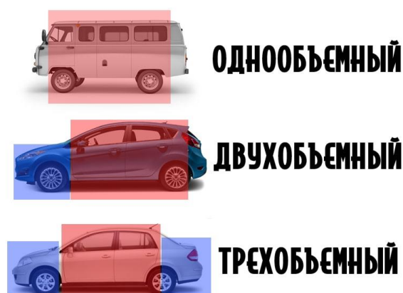
Рис. 1. Классификация кузовов по числу объемов (градация по визуальному признаку объемов)
