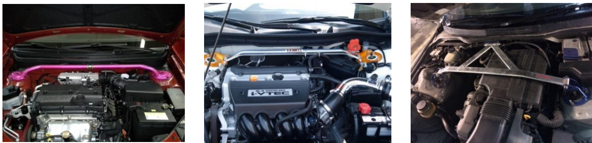
Рис. 3. Регулируемая, двух- и трехточечные распорки передних стоек
