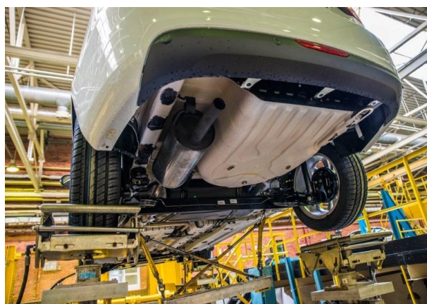
Рис. 2. Измерение жесткости кузова на кручение в лабораторных условиях
